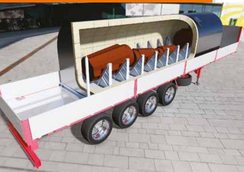
Termos do transportu materiałów gorących do 1000 °C i masie 30 ton.
